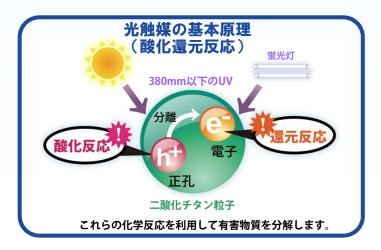
酸化チタンなどの光触媒半導体金属を触媒に、光エネルギー(紫外線)を利用して、表面で生じる化学反応により様々な物質を分解します。
